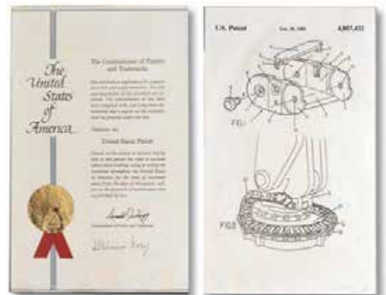
1989 Patent für die kreisförmig drehende Energieführungskette aus Kunststoff.
