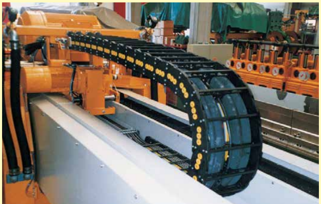
Energieführungskette aus Kunststoff (Modell 310) mit Vorspannung
