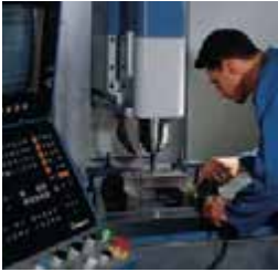
Spritzgiessformen zur Fertigung verschiedenartiger Teile werden mit modernen NC-Maschinen hergestellt.
