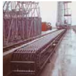
Energieführungskette Serie BS 35 mit Unterstützungswagen für die Enteisung von Flugzeugen auf dem Flughafen München.
